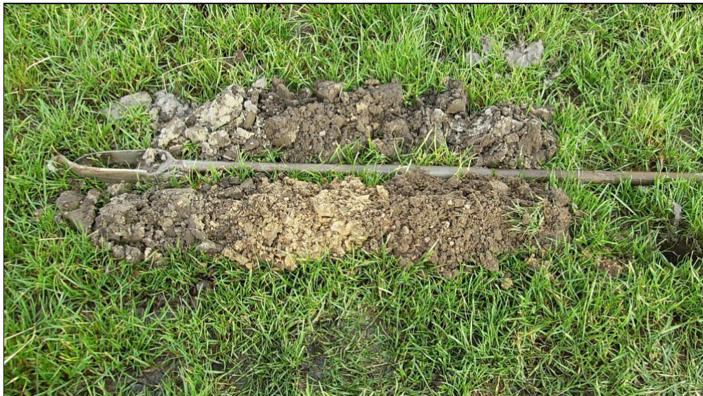
Afbeelding 3. Beeld van boring 5 met op de voorgrond de eerste meter van het profiel en op de achtergrond de 2 e m. Daar waar de vulling grijzer wordt, loopt de boor leeg.
