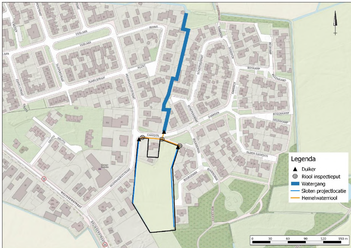
Figuur 7: situering sloten en afwatering.
