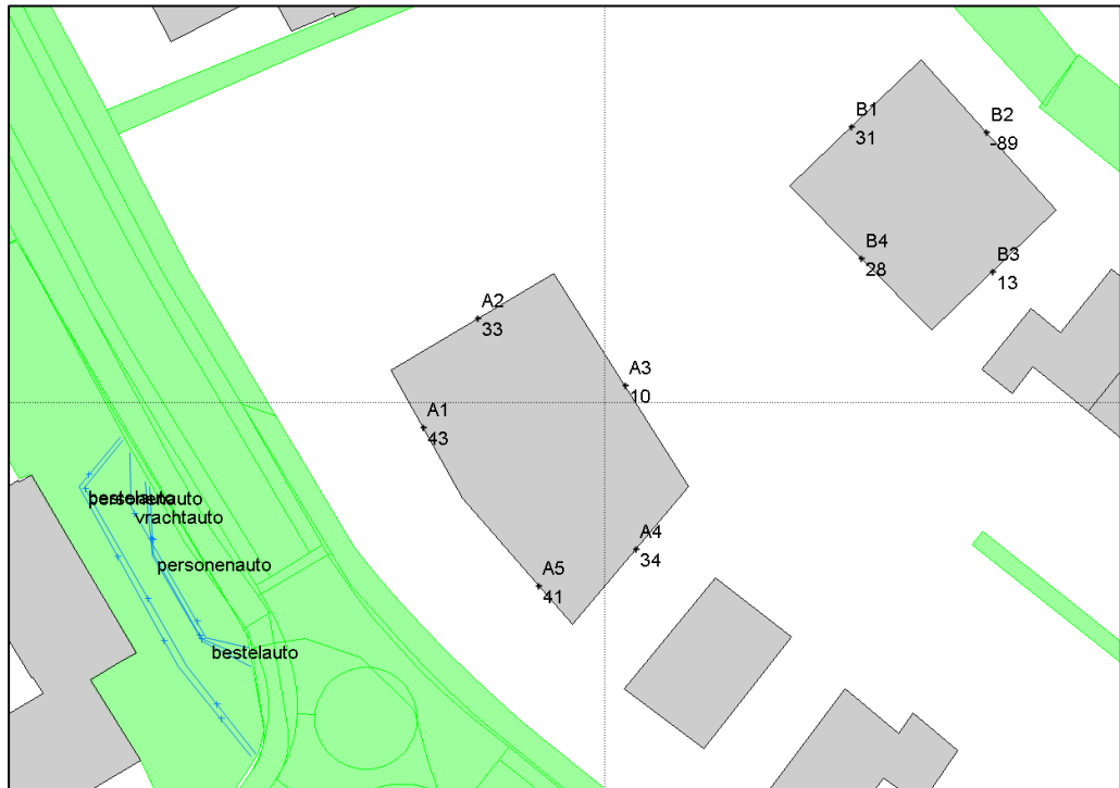
Figuur 5 Berekende geluidbelasting vanwege het onbemande tankstation (etmaalwaarde)
