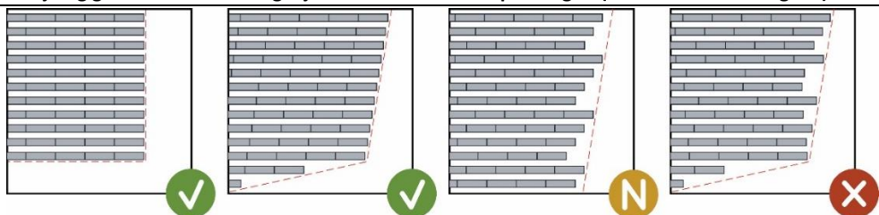
Figuur 9 Uitlijning gebeurt zo recht mogelijk: een van de linker oplossingen (Schematische weergave).
