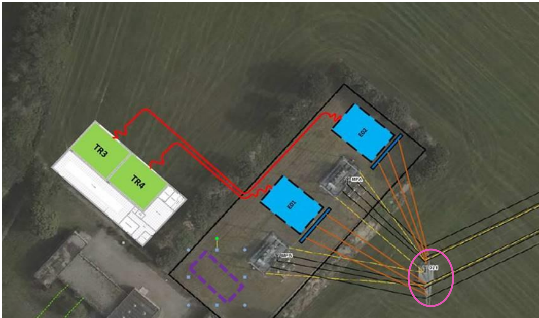
Afbeelding 1.2 Voorgenomen werkzaamheden. Blauw zijn de te realiseren hoogspanningsvelden die in voorliggende rapportage worden getoetst en de hoogspanningsmast waar de fundering wordt aangepast is roze omcirkeld. Groen zijn de transformatoren op het perceel van Liander en worden buiten beschouwing gelaten.
