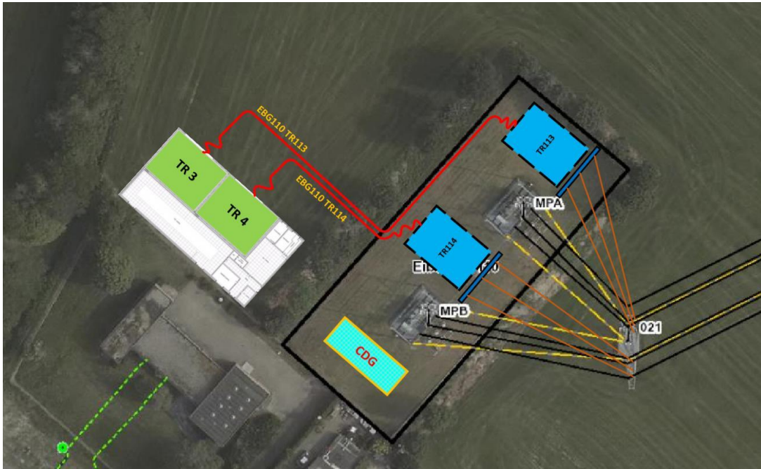
Figuur 1 Inrichtingsschets van de geplande uitbreiding met de ligging van de nieuwe kabeltracés (rood), het CDG (paars) en transformatorvelden (blauw). De nieuwe transformatoren (groen) vallen niet onder dit onderzoek
