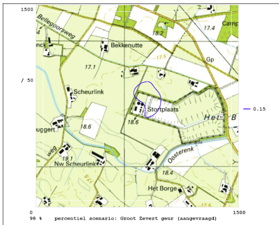
Figuur c Geurcontouren van 0,15 ouE/m 3 als 98-percentielwaarde als gevolg van Groot Zevert Vergisting in de aangevraagde situatie.
