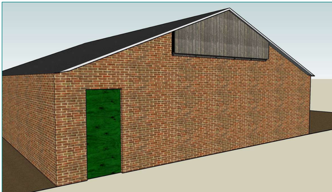
Figuur 5: Vleermuisgevelkast. Overzicht met detailuitwerking - maatvoering in het werk en minimaal 122x244.
