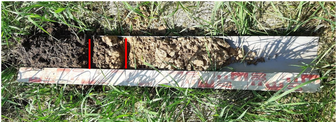
Afbeelding 15: Boorkern van boring 3, met van links naar rechts achtereenvolgens de grijsbruine bouwvoor, de menglaag (A/C-horizont) en de natuurlijke ondergrond (dekzand).
