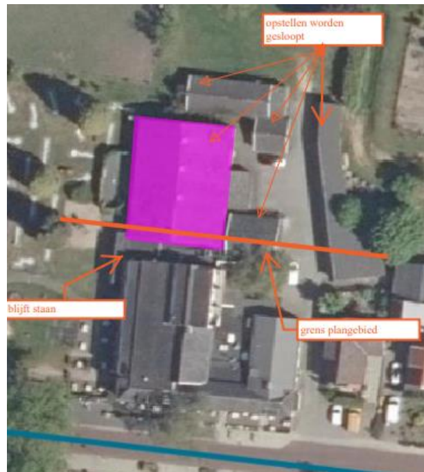
Figuur 1 Bron: conStabel te slopen opstallen
