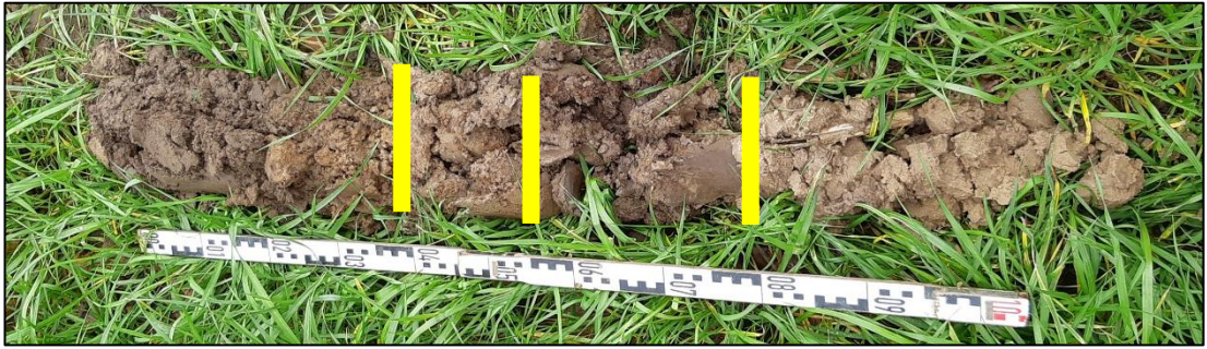
Afbeelding 18: Boring 35 met achtereenvolgens de Ap1-horizont, de Ap2-horizont, de A/C-horizont en de C-horizont
